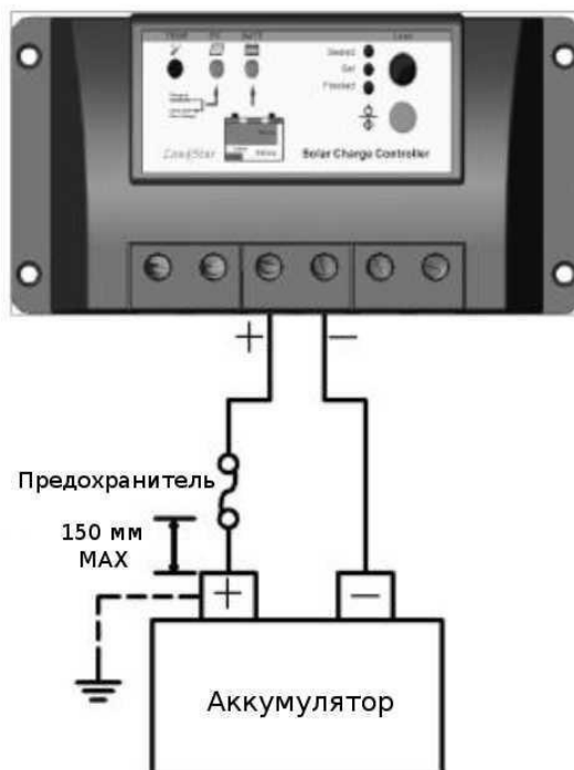
Рис. 3.2. Подключение аккумулятора
