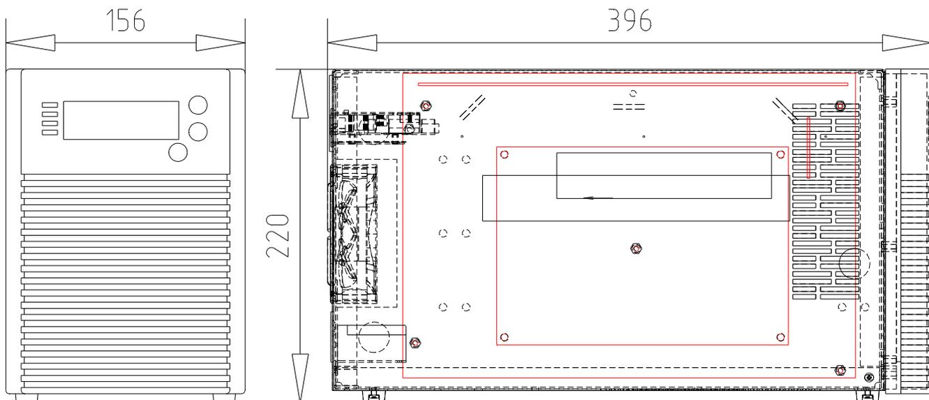
Рисунок 1.1 – Внешний вид ИБП Штиль ST1101SL.
