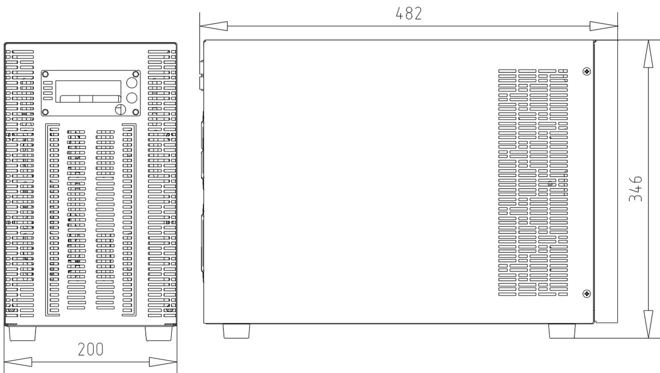
Рисунок 1.3 – Внешний вид ИБП Штиль ST1102SL и ST1103SL.
