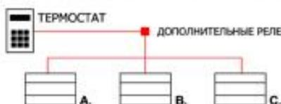
К одному комнатному термостату можно подключить до 4 газовых конвекторов «Бета Электроник», что могут оценить владельцы
